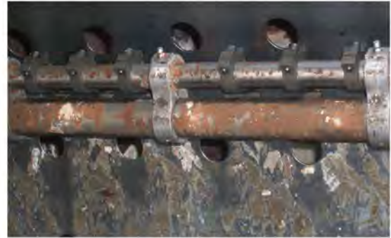
写真14 錆びてしまった枚葉機デリバリー爪竿
