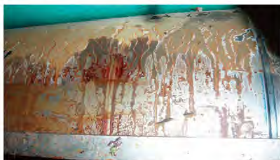
写真20 錆びてしまった枚葉機の圧胴
