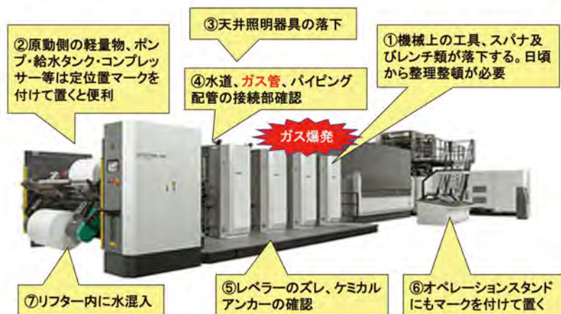
図10 輪転機の確認箇所
