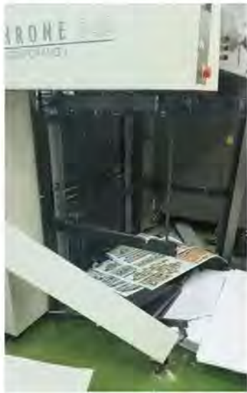
写真1 熊本地震でデリバリー部分が破損した枚葉機
